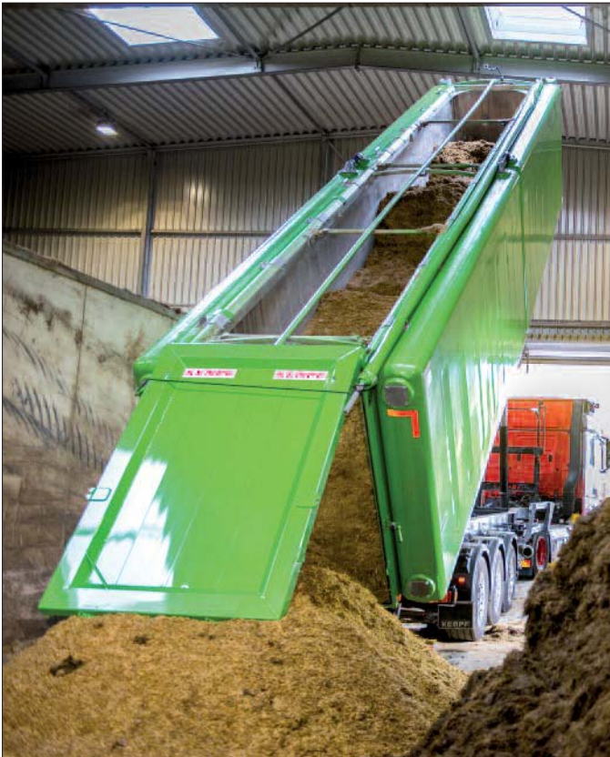
Multifunktionaler Sattelaufleger mit Hinterkippmulde für Schüttgüter und seitlich montierten Flüssigkeitstanks zur Aufnahme von flüssigen Nichtgefahrenstoffen.
