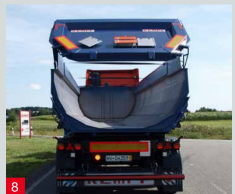
[5] Ladekran vor der Stirnwand, auf dem Chassis montiert, hydraulisch klappbares Dach, Flügeldeckel aus 10 mm Kunststoff
