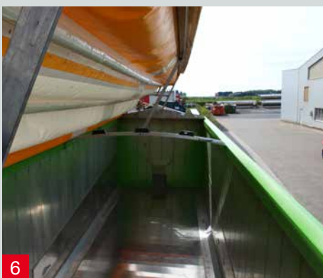
[1] [2] [3] Coilmulde mit Einsteckungen, Zurringen und Ablagekasten an der Stirnwand
