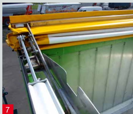
[4] hydraulische Schütte, 400 mm hoch, 120° Öffnungswinkel, pneumatisch angesteuert
